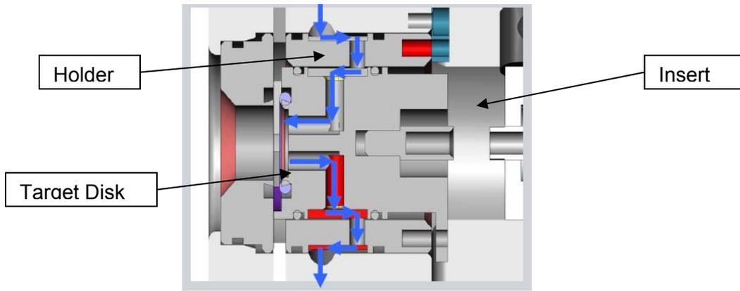
**Figure 12 : Cooling Path**
