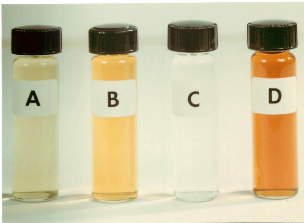
Figure 23. Solutions of Pr(III) (A), Pr(IV) (B), Tb(III) (C), and Tb(IV) (D) in 5.5 M \text{K}_2\text{CO}_3 .
