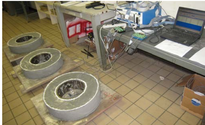
Fig. 2.9. AASHTO PP34 test setup
